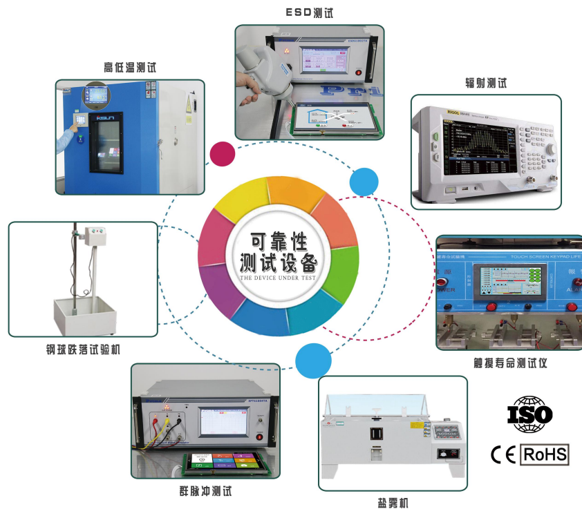
图 6-1 可靠性测试设备
